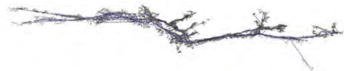
(a) 点群データと骨格化結果（青点：骨格，黒線：トポロジー）
