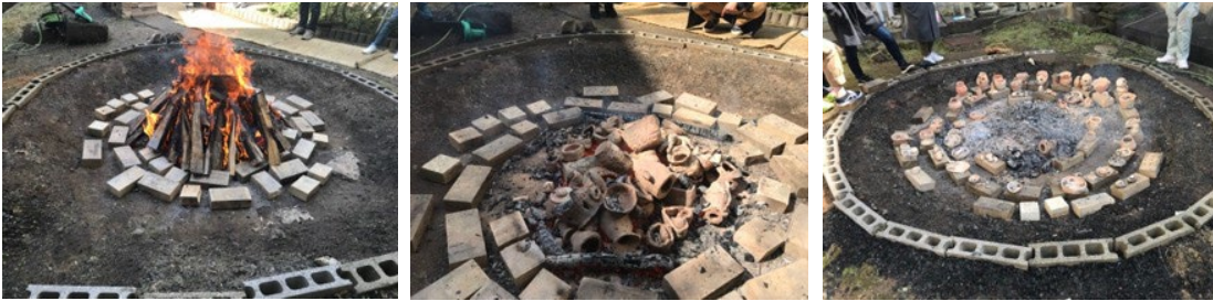
図2 土器焼き。1時間ほど空焼きして火床を作り、その上に土器を並べ、薪を投入し本焼きを1時間ほど行う。火が消えたら、土器を取り出し、ゆっくりと冷やす。
