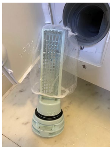
フィルターに水切りネットを取り付け
