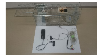
捕獲器、閉扉機構、 制御用マイコン、 焦電センサ、カメラ、餌箱、 バッテリー、StickPC 図5 自動捕獲装置の構成
